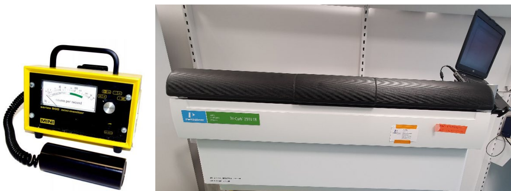
Figur 5 GM-rör till vänster och scintillationsräknare till höger.
