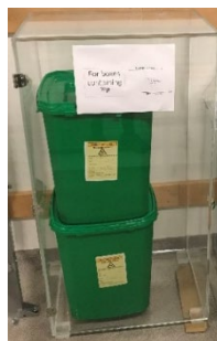
Figur 7 Gröna avfallsbehållare kan behöva extra strålskydd, ex plexiglas för högenergetiskt betastrålande isotoper.
