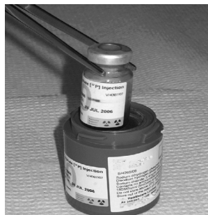
Figur 6 Tång/pincett ska användas vid arbete med gamma- och högenergetiskt betastrålande isotoper.
